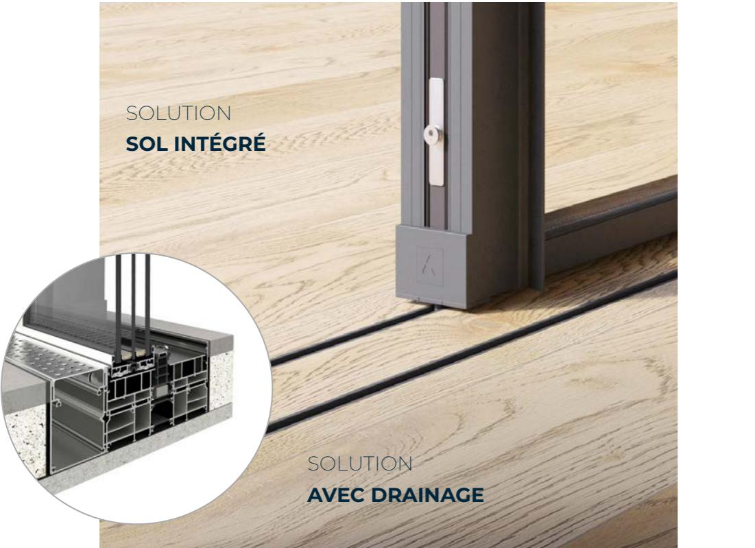
Possibilité d'encastrer le profilé inférieur et intégrer à la finition du sol, (parquet, revêtement du sol, céramique...), obtenant une transition sans aucun type d'obstacle entre l'intérieur et l'extérieur au logement.
